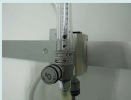
Auf richtiges Ablesen achten! Kugel Oberkante, Mitte oder Unterkante? Das ist nicht immer gleich. (Bild: 4 Liter „Oberkante“ Kugel)
